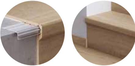
APLICAÇÃO 5 Perfil de acabamento em escadas e degraus. O perfil Incizo também permite fazer o acabamento em escadas e degraus com o design de sua preferência. Para esta aplicação, você precisará utilizar o perfil Incizo e um subperfil de alumínio. Os subperfis deverão ser encomendados separadamente.
